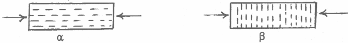
Δοκίμιο ξύλου σε αξονική θλίψη (α) και εγκάρσια θλίψη (β)
